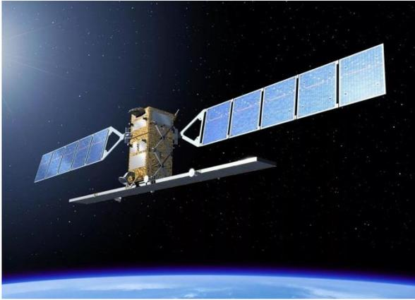
КА серии COSMO Skymed оснащен плоской антенной панелью 5.7 x 1.4 метра.
